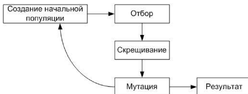
Рис.1. Общая схема работы генетического алгоритма
