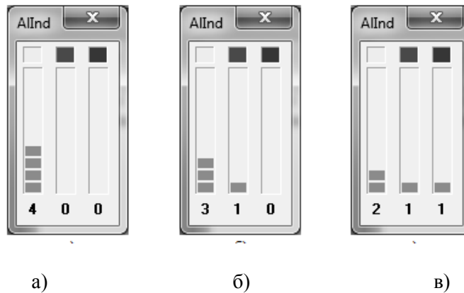
Рис. 2.8. Форми індикації: а – прогнозується чотири ПКС (ідентифікується жовтим кольором – перший стовпчик); б – одна з ПКС перейшла в стадію «передконфліктної ситуації» (ідентифікується малиновим кольором – другий стовпчик), в – одна з ПКС перейшла в стадію «конфліктної ситуації» (порушення інтервалів ешелонування), ще одна з ПКС – в стадію «передконфліктної ситуації» (ідентифікуються малиновими (другий стовпчик) та червоними (третій стовпчик) кольорами
