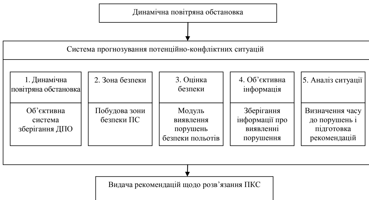
Рис. 2.9 Структурна схема та алгоритм функціонування системи випереджаючого моделювання МК Fusion
