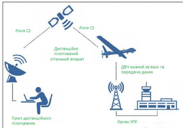
Рис.2. Зв'язок за межами RLOS(BRLOS) через ретранслятор (як правило, супутник)
