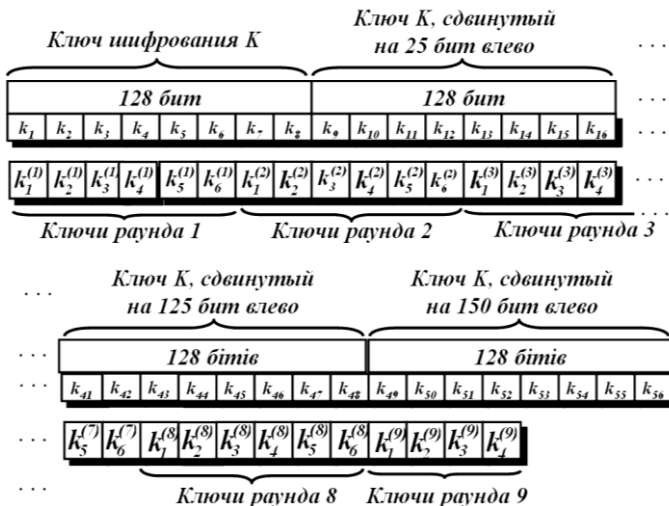
Рис. 9.5. Процесс получения раундовых ключей шифрования
