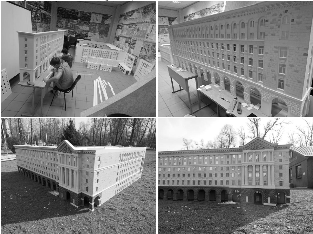
Рис.12. Процес склеювання фасадної частини, фарбування та остаточної зборки
