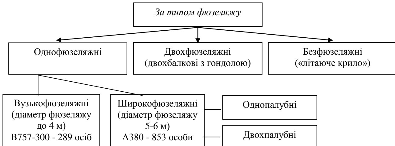
Рис. 9. Класифікація ПС за типом фюзеляжу
