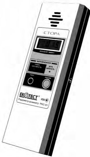
Рис. 5.3. Радіометр-дозиметр гамма-бета-випромінювань РКС-01 “СТОРА”
