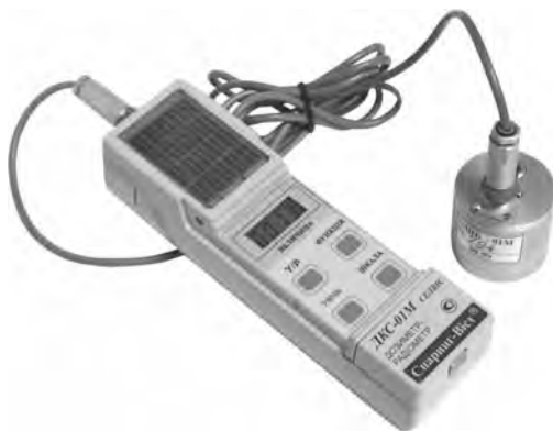
Рис. 5.1. Дозиметр-радіометр гамма-бета-випромінювань ДКС-01 “СЕЛВІС”
