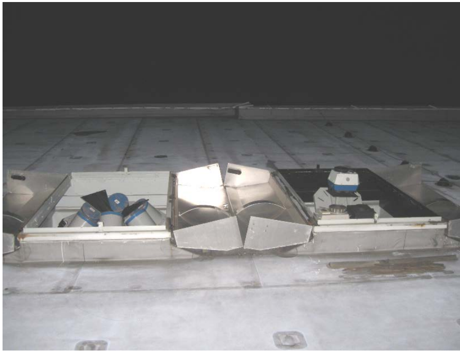
Рис. 2.3. Метеорний патруль Астрономічної обсерваторії Астрономічного інституту Академії наук Чеської Республіки в м. Ондржейов. Використовуються камери Tessar (світлосила 1:4.5; F=360 мм) [19].
