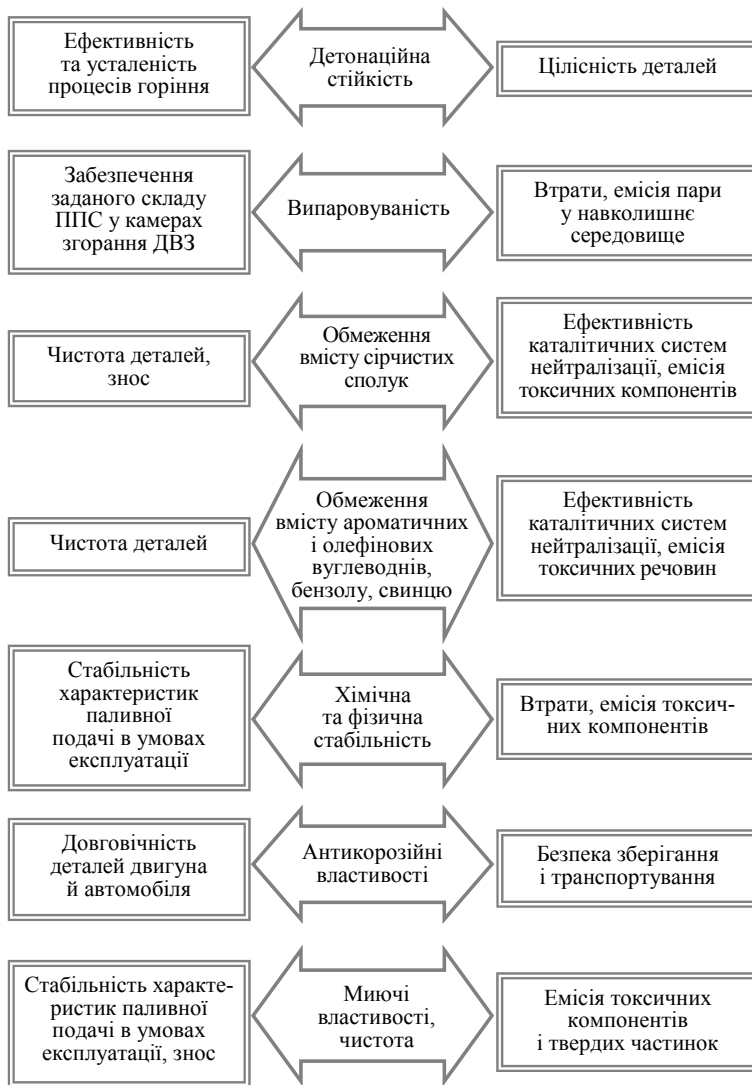
Рис. 2.8. Взаємозв'язок експлуатаційних властивостей автомобільних бензинів і технічних показників техніки
