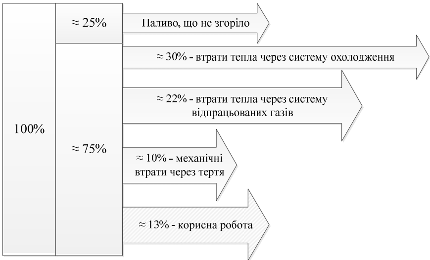
Рис. 1.4. Розподіл енергії в двигуні внаслідок згорання палива
