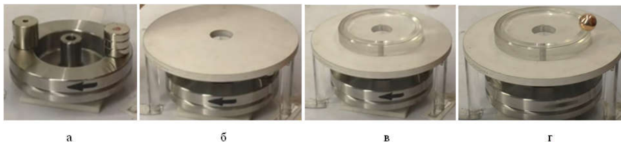
Рис. 11. Изображение механической системы для демонстрации действия магнитного поля на медный шарик, где: а) вращающаяся латформа с двумя круглыми неодимовыми магнитами; б) маховик с магнитами и неподвижный столик из изоляционного материала; в) круглая подставка с пазами, расположенными по окружности для направления движения шарика по замкнутому контуру; г) собранная конструкция механической системы замкнутого типа
