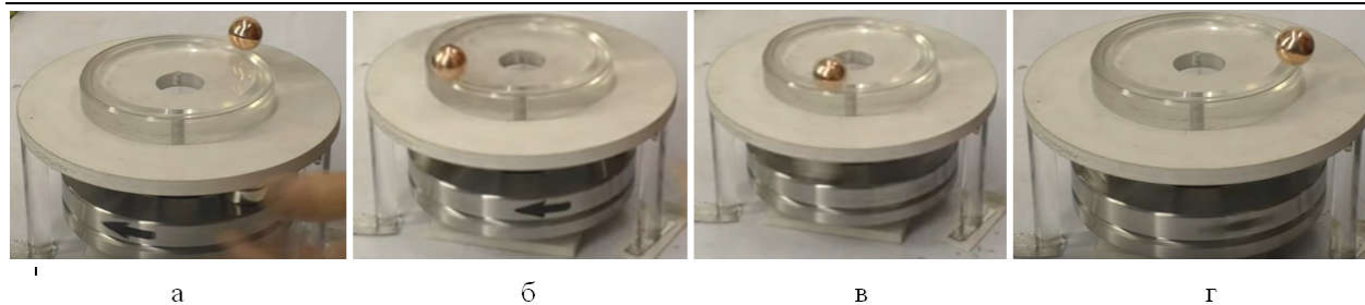
Рис. 12. Вращение медного шарика против часовой стрелке при вращении маховика с магнитами по часовой стрелке
