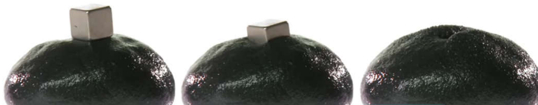
Рис. 17. Иллюстрация эффекта поглощения магнитным пластилином неодимового магнита в форме куба
