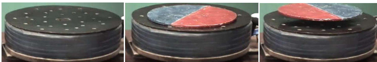
а б в Рис. 7. Иллюстрация магнитопольевого эффекта взаимодействия полей электромагнита и алюминиевого диска
