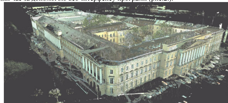
Рис. 1. Результат сканування у вигляді хмари точок
