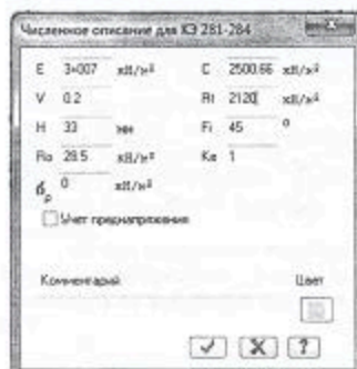
Рис. 12. Задание жесткости для специальных пластинчатых элементов КЭ284: а – диалоговое окно "Жесткости элементов"; б – диалоговое окно "Численное описание для КЭ 281-284"
