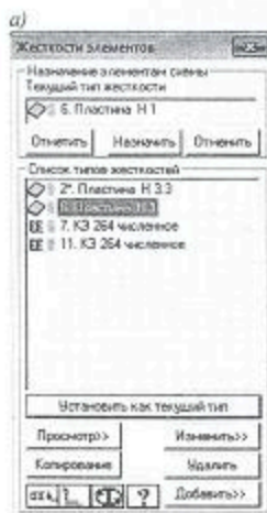
Рис. 10. Задание жесткости специальных КЭ264: а – диалоговое окно "Жесткости элементов"; б – диалоговое окно "Численное описание КЭ264"
