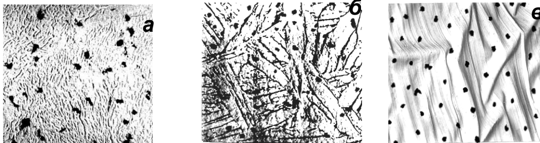
Рис. 2. Автордиограммы-реплики срезов, параллельных поверхности, на глубине \sim 10 мкм после мартенситного \gamma \rightarrow \alpha превращения и создаваемой им деформации (а – образец, Fe-30 % Ni), после деформации (б – оправка, Fe-31 % Ni, \alpha - фаза) и на поверхности сплава Fe-33 % Ni после \gamma \rightarrow \alpha превращения без оправки, т.е. без дополнительной деформации (в), \times 9800 .
