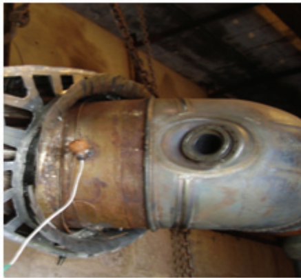
Рис. 4 Дослідний зразок газового ежектора на стаціонарному ГТД
