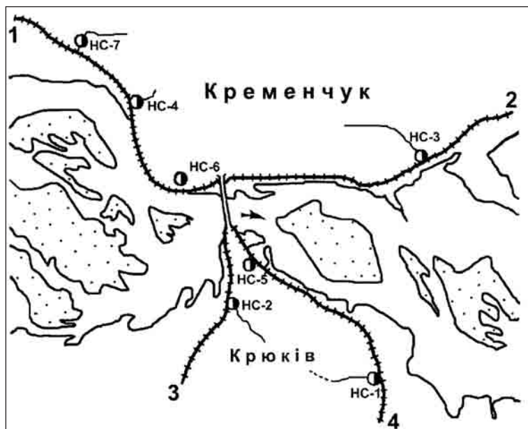
Рис. 3.1. Схема захисних споруд від підтоплення і затоплення м. Кременчук: 1—4 — відповідно Західно-Кременчуцька, Східно-Кременчуцька, Західно-Крюківська і Східно-Крюківська дамби
