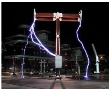
Рис. Пробій в газах унаслідок його іонізації
