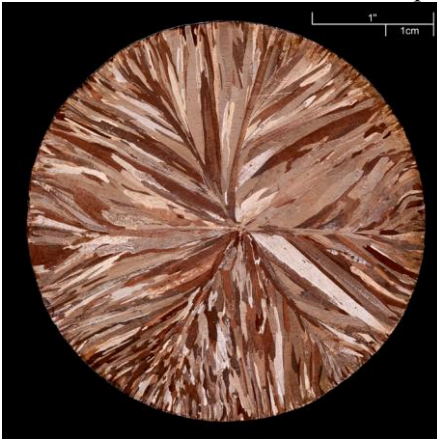
Рис. Мідний стержень. Технологія неперервного лиття.
