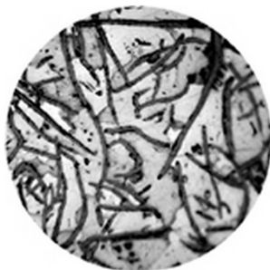
СЧ 15 (ферит, графіт крабоподібний) Сірий чавун на ферритній металевій основі. Темні включення крабоподібного(пластинчастого) графіту в ферритній матриці.
