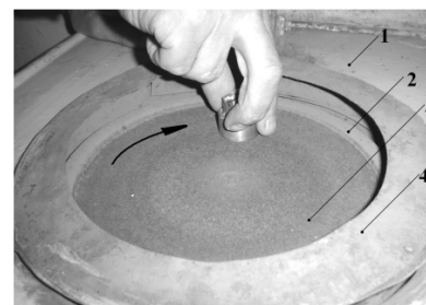
Мал. 1.6. Рекомендований прийом полірування шліфа на полірувальній установці: 1 – стіл полірувальної установки, 2 – диск, 3 – сукно, 4 – захисний кожух
