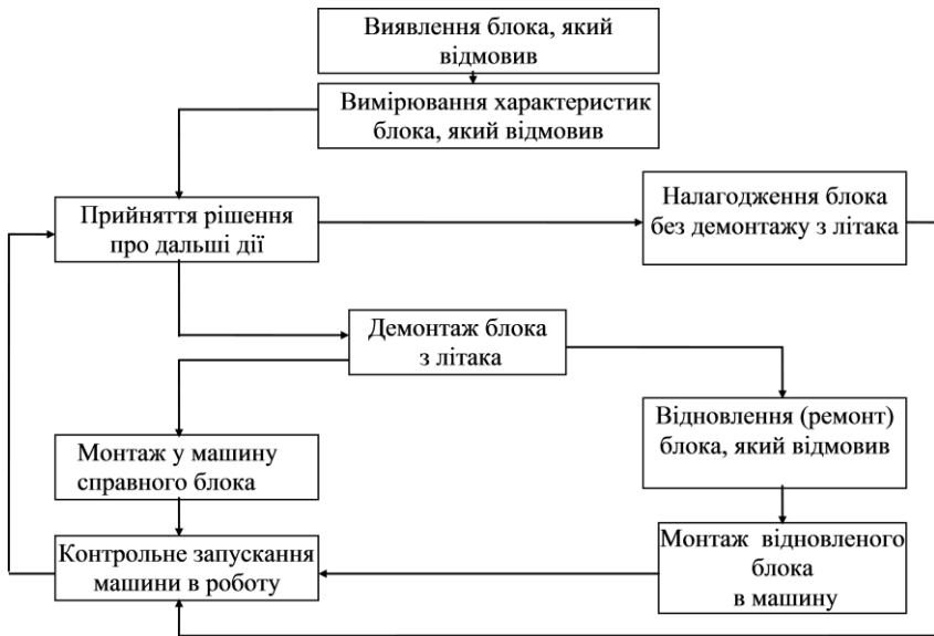
Рис. 4.6. Схема дій оператора у відновлювальній ергатичній системі
