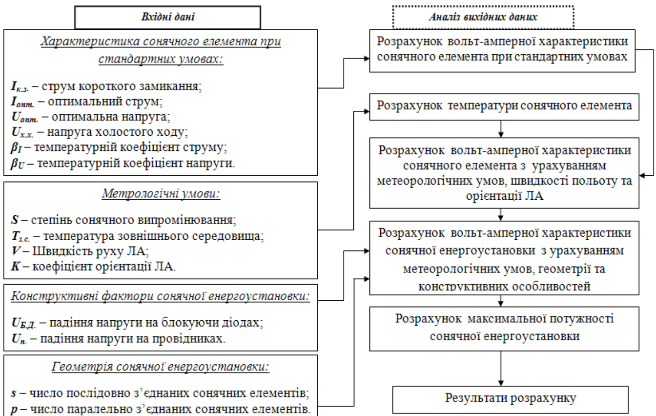
Рис.2.14. Алгоритм розрахунку робочих характеристик сонячної енергоустановки літака
