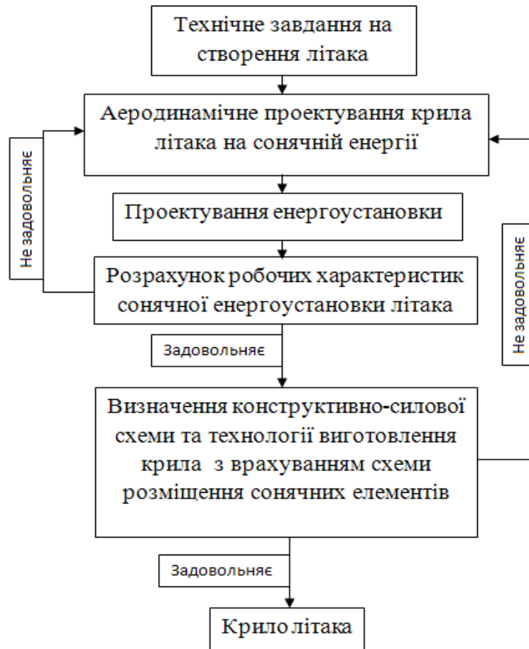
Рис.3.22. Алгоритм створення крила літака на сонячній енергії
