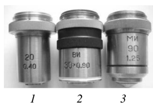
Рис. 1.8. Типи об'єктивів: 1 – сухий об'єктив; 2 – «ВИ» – водна імерсія, білий обідок; 3 – «МИ» – олійна імерсія, чорний обідок
