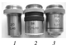
Рис. 2. Типи об'єктивів: 1 – сухий об'єктив; 2 – «ВИ» – водна імерсія, білий край; 3 – «МИ» – олійна імерсія, чорний край
