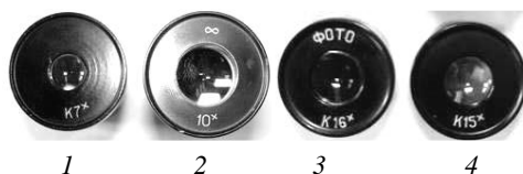
Рис. 3. Типи окулярів: 1, 4 – компенсаційні окуляри; 2 – окуляр Гюйгенса; 3 – компенсаційний фотоокуляр
