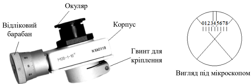
Рис. 6. Окуляр-мікрометр
