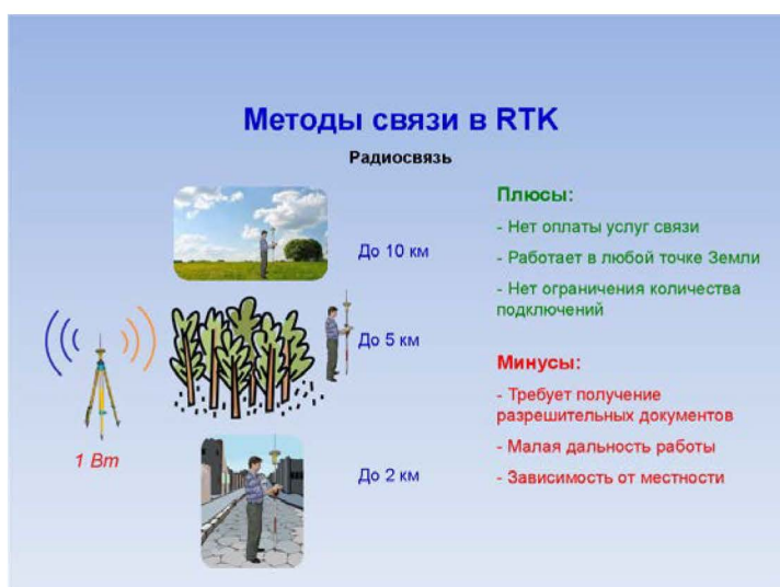
Рис. 2.1. Плюсы на минусы УКХ (ультракороткохвильового) радіозв'язку
