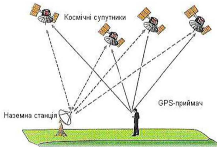
Рис. 1.1. Спрощена схема функціонування GPS
