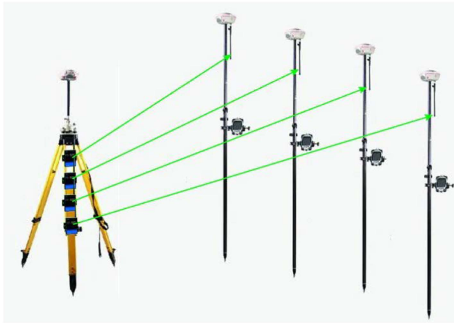
Рис. 2.7. Кількість GSM модемів з СИМ-картками повинна дорівнювати кількості роверів для прийому поправок з одного Бази.
