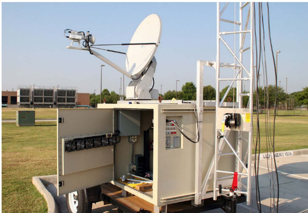
Рис. 1.5. Супутникова антена зв'язку для дистанційного керування і завантаження даних (ККС)
