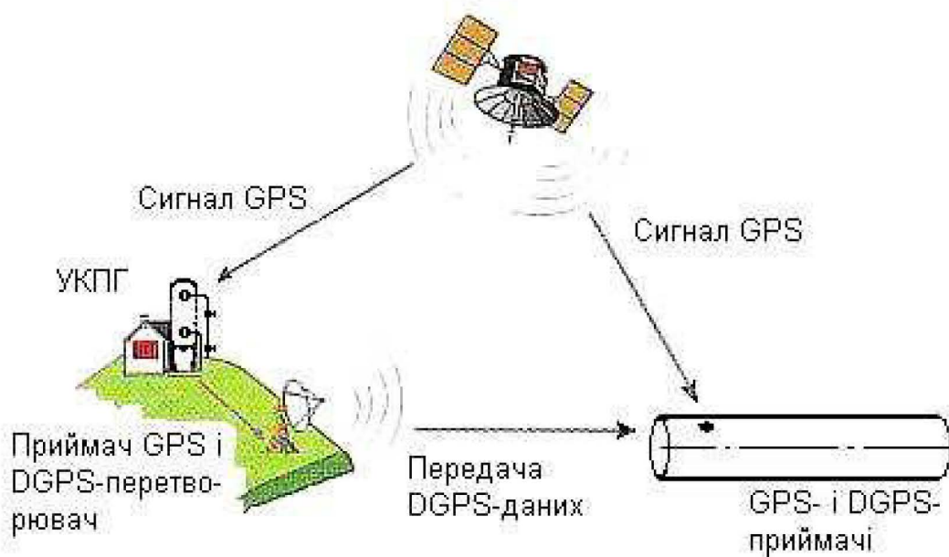
Рис. 1.2. Метод диференційованої корекції DGPS
