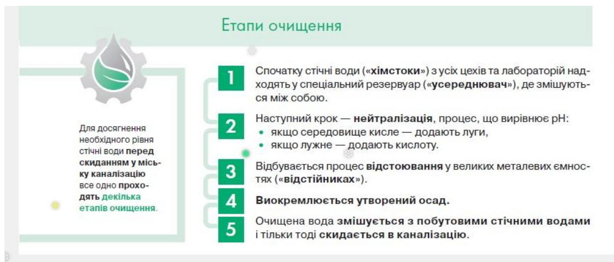
Рис.2.1Схема очистки стічних вод на АТ «Фармак»
