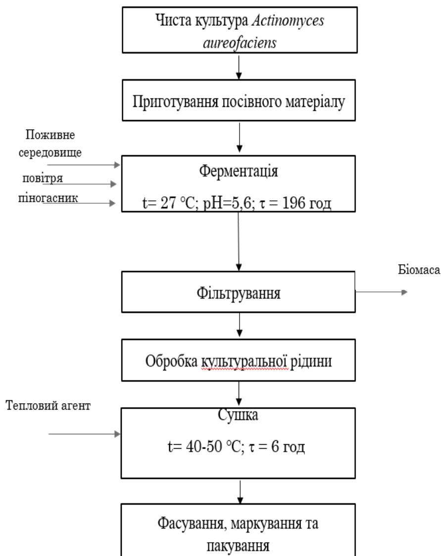
Рис. 3.4. Схема виробництва антибіотиків в процесі мікробіологічного синтезу.
