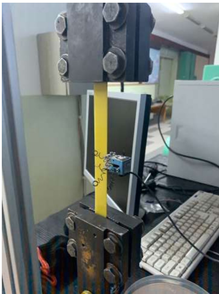
Рис.3.4 Схема закріплення зразка в сервогідролічній машині
