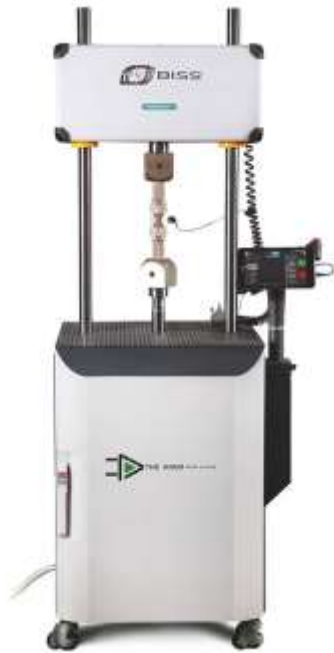
Рис.3.2 Сервогідролічна машина із цифровим керуванням BiSS Vi-00-202V
