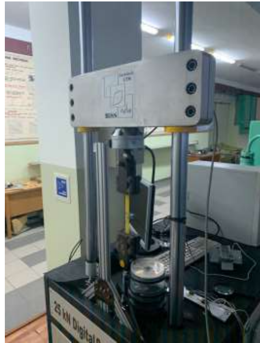
Рис.3.2 Сервогідролічна машина із цифровим керуванням BiSS Vi-00-202V
