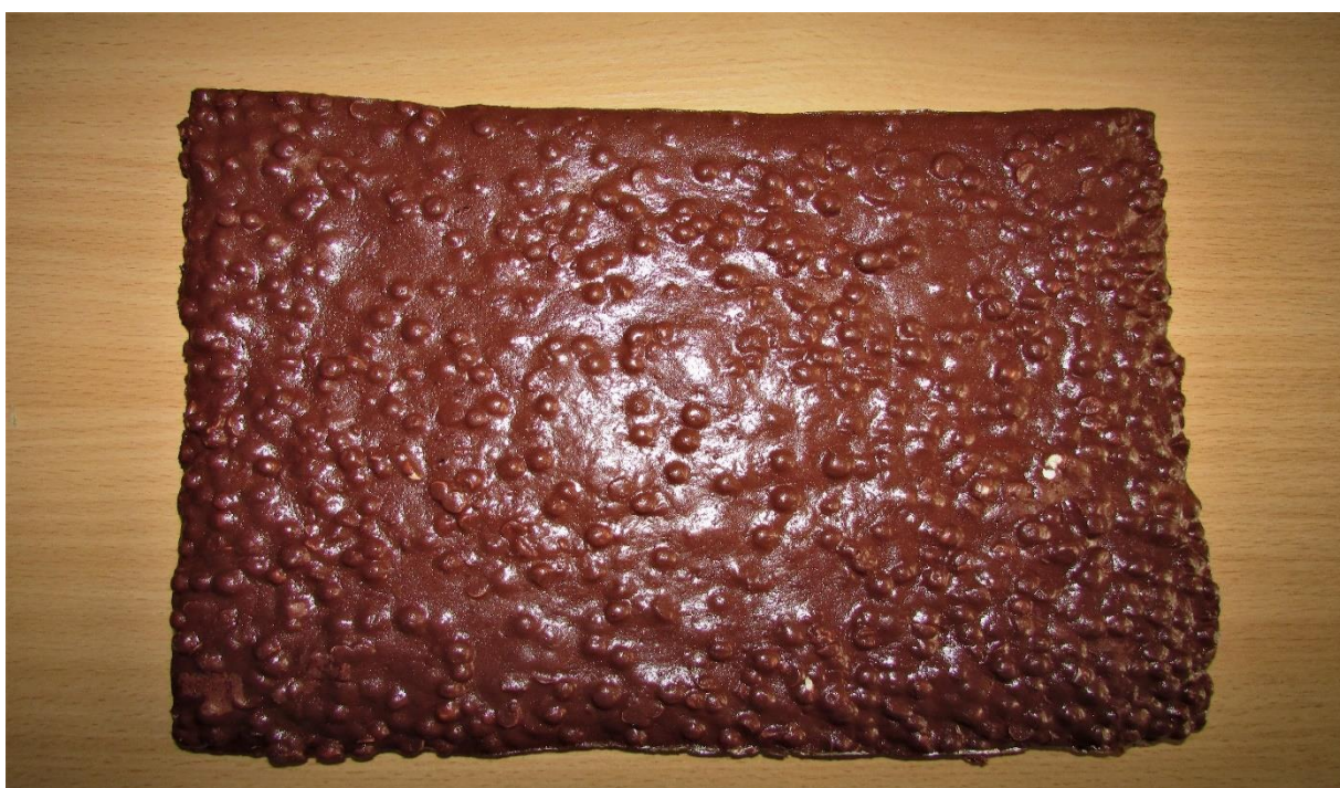
Рис. 5.69. Зовнішній вигляд універсальних електромагнітних та шумозахисних екранів: а) на основі пінолатькесу; б) на основі пінолатькесу та пінополістиролу
