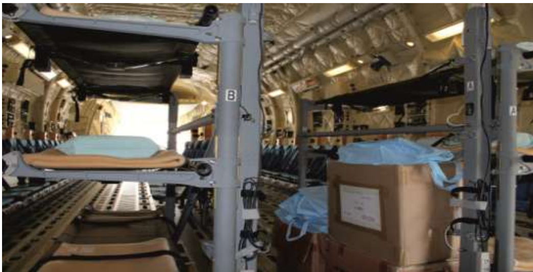
Рисунок 1.21 – Розміщення нош у вантажній кабіні для перевезення поранених
