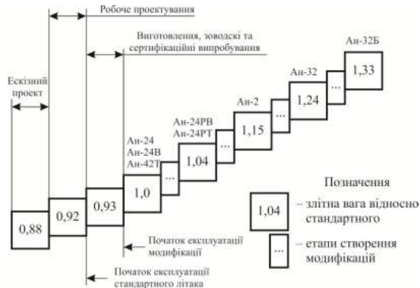
Рисунок 1.15 – Зміни стартової і злітної мас літака Ан-26 та його модифікації по етапах їх створення та експлуатації
