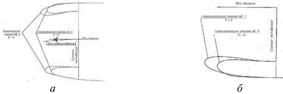
Рисунок 4 – Вертикальне (а) та горизонтальне (б) сечення повітрязбірників мотогондол МГ-5 і МГ-7
