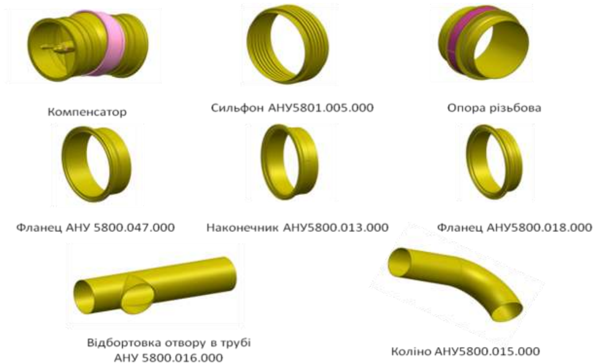
Рисунок 28 – Елементи для виготовлення трубопроводів
