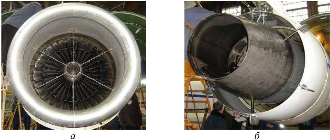
Рисунок 3 – Установлення гребінок приймачів тиску у повітрозбірнику (а) і соплі вентиляторного контуру двигуна (б)
