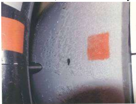
Рисунок 8 – Відкладення льоду на внутрішніх каналах повітрязбірника
