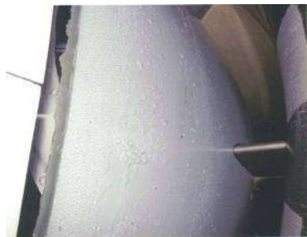
Рисунок 8 – Відкладення льоду на внутрішніх каналах повітрязбірника
