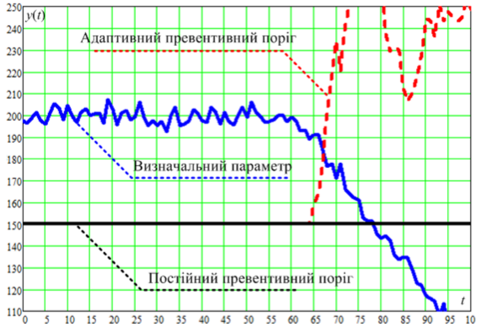
Рис. 4.21. Оцінка адаптивного порогу за результатами оброблення тренду визначального параметру
