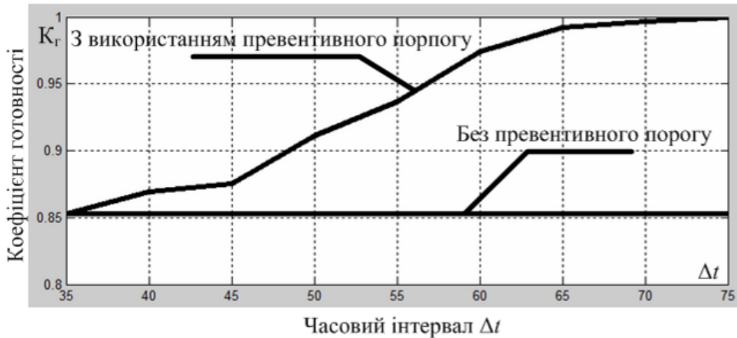
Рис. 4.9. Оцінки коефіцієнту готовності у випадках використання та відсутності превентивного порогу
