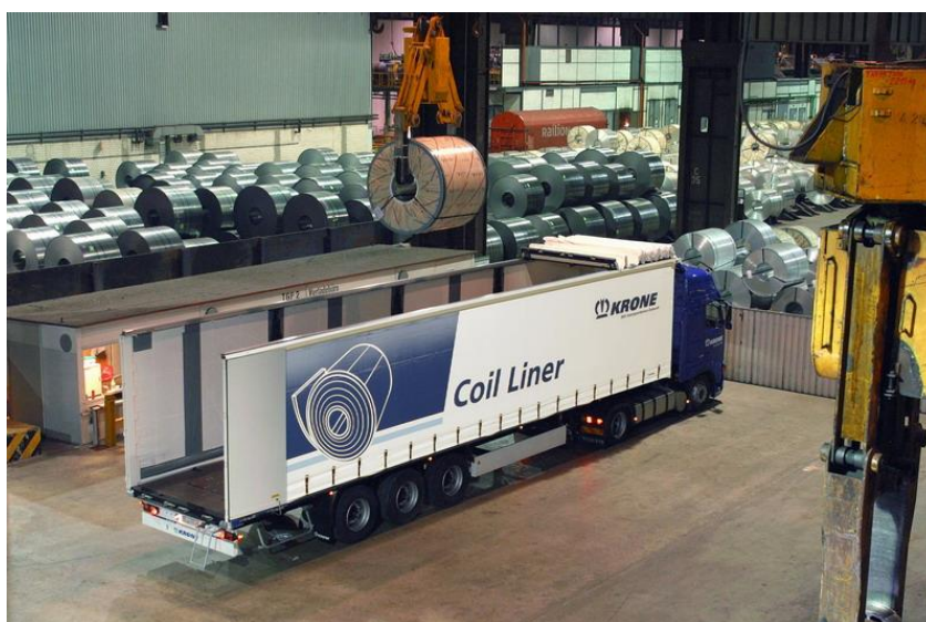
Рис. 3.8. Укладання металопрокату в кузов автомобіля з пересувним тентом [26]
