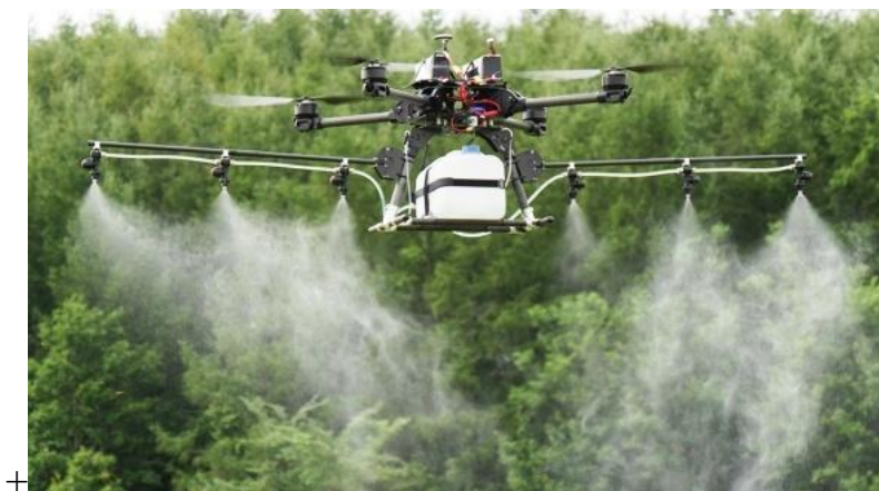
Рис.3.2. Обприскування з використанням безпілотного літального апарату
