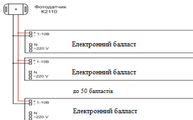
Рис.2.10.Схема управління диммируемими балластами (ЕПРА) за допомогою датчика освітленості K2110.
