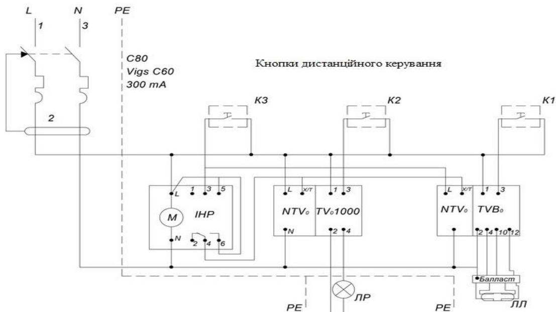
Рис. 2.6. Принципова схема освітлювальної мережі з світлорегуляторами
