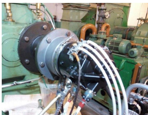
Рис.1.7. Испитові стенди типу GRA з навісним електрообладнанням СЕП
