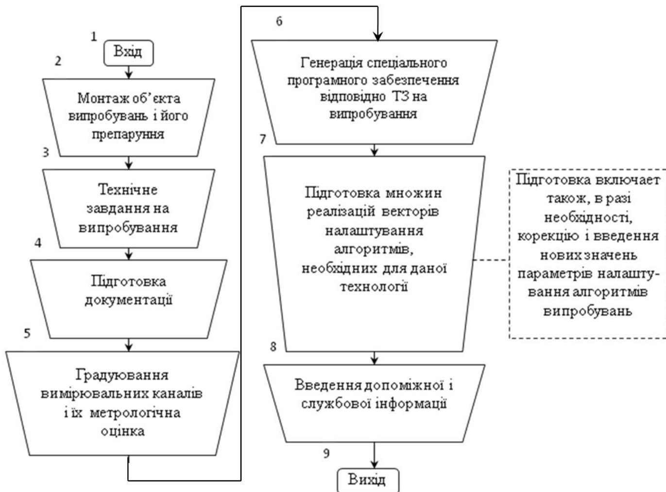
Рис. 2.3. Алгоритм робіт підготовки випробувань ФС авіоніки ПС
