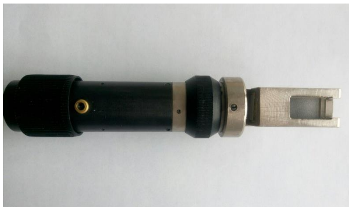
Рис. 2.7. Рефрактометр ручний РР-1
