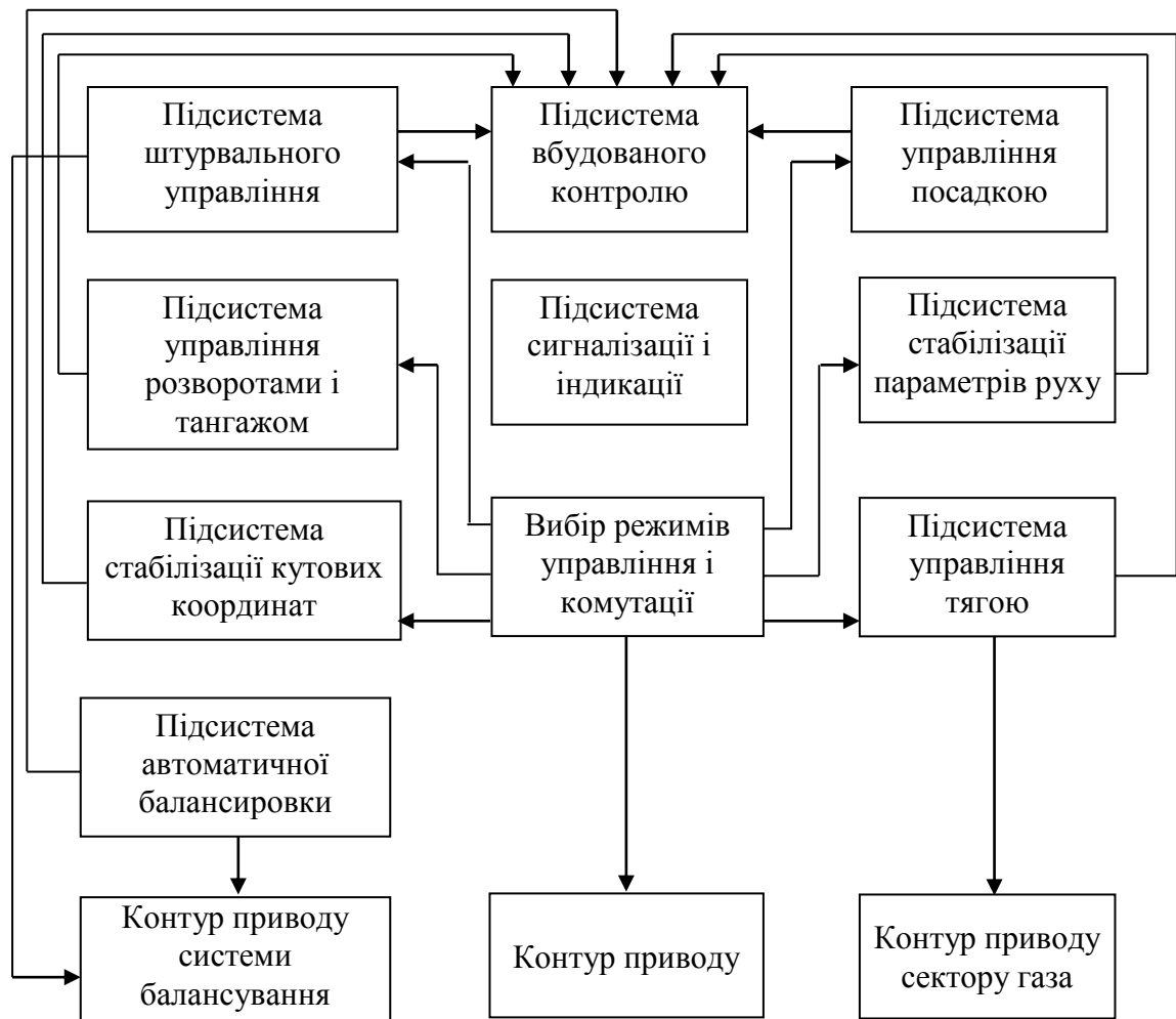
Рис. 2.21. Структурно-функціональна схема автоматизованої системи управління літальним апаратом
