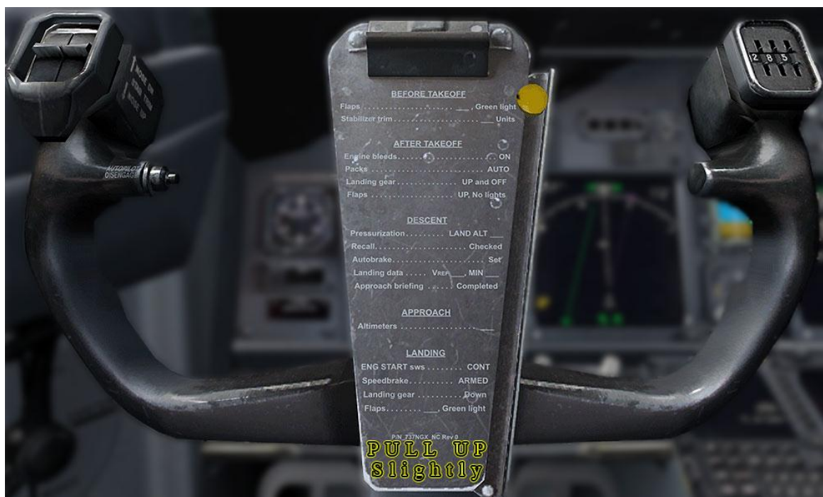
Рис 6.5. Індикація спрацювання сигналізатора попередження про недопущення різких рухів на штурвалі літака
