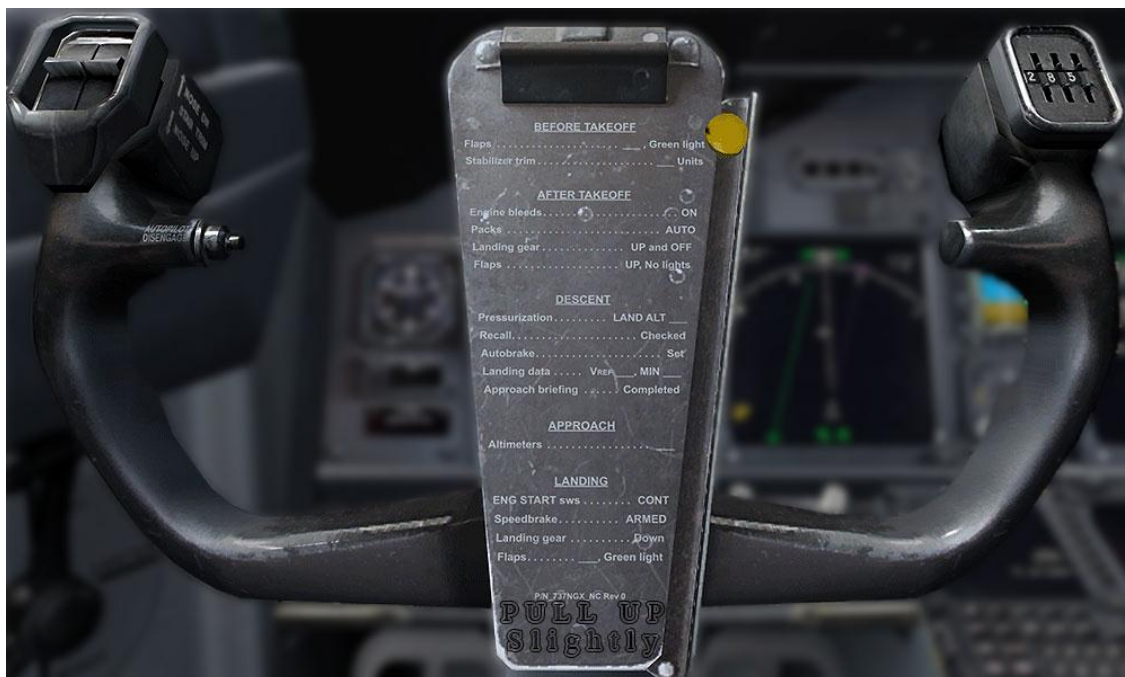
Рис 6.4 – Індикація сигналізатора попередження про недопущення різких рухів на штурвалі літака при вимкненій сигналізації
