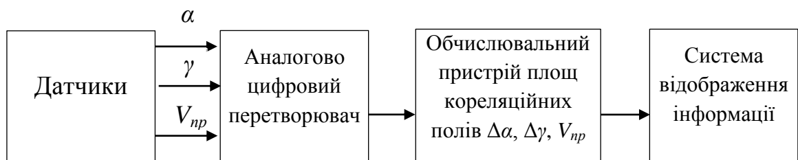
Рис. 6.6 – Система сповіщення про вихід з ладу одного з датчиків
