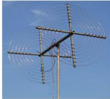
Рис.1.5. Антена з двома плоскими спіралями Тесла
