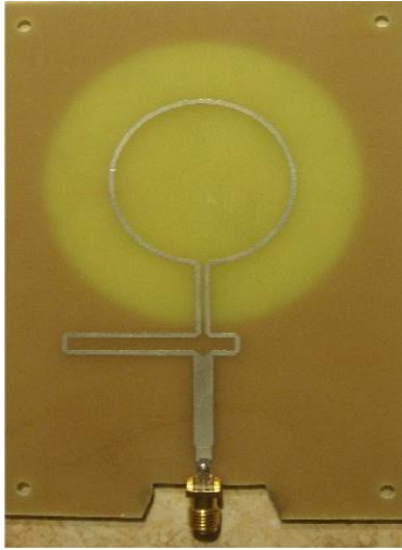
Рис. 4.18 Мікросмушковий кільцевий антенний елемент на підкладці склотекстоліту FR-4.
