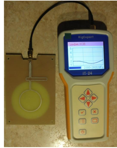
Рис. 4.19 Вимірювання кільцевого випромінюючого елемента за допомогою антенного тестеру RigExpert IT-24.
