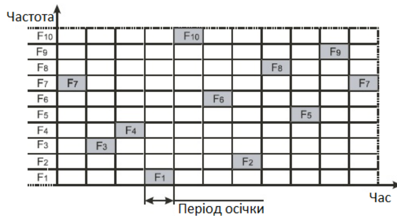
Рис. 3.2. Принцип дії алгоритму Frequency Hopping Spread Spectrum [34]
