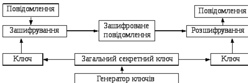
Рис. – 2.4 – схема симетричного шифрування
