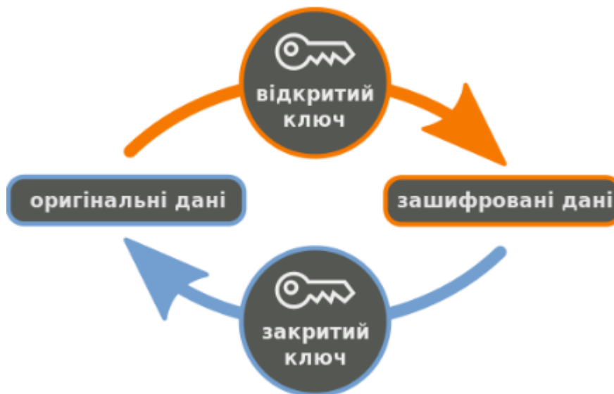
Рис. – 2.3 – схема асиметричного шифрування
