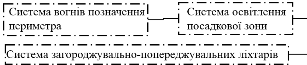
Рисунок Г.8 - Схема функціональної стійкості світло-сигнальної і освітлювальної системи гвинтокрильних палуб рухомого об'єкту водного транспорту
