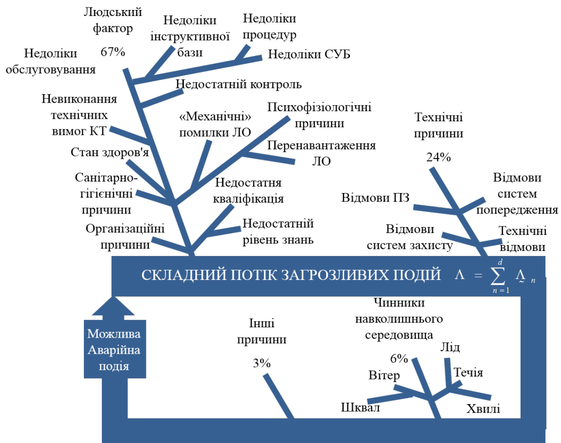
Рисунок 1.2 - Удосконалена діаграма Ісикави для відображення складних динамічних причин аварій рухомих об'єктів водного транспорту з системами динамічного позиціонування
