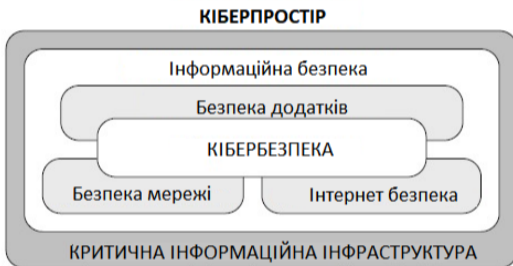
Рисунок 2.1 – Зв'язок терміну “кібербезпека” з термінологічним базисом стандарту ISO/IEC 27032
