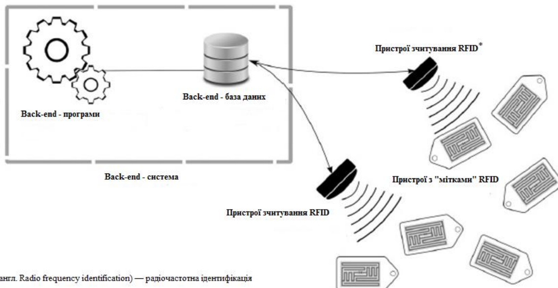
Рисунок 3.8 – Приклад системи RFID
