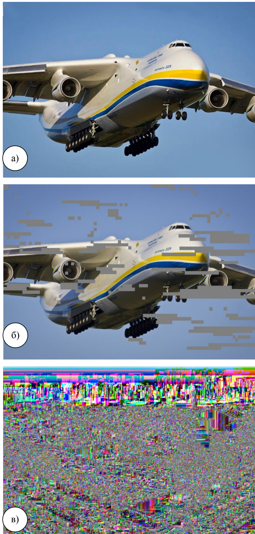
Рисунок 1.9. - Руйнування відеокадрів у ході передавання відеотрафіку у наслідок: а) відеокадр у разі відсутності дисбалансу б) зростання часу затримки пакетів; в) збільшення відсотку втрачених пакетів
