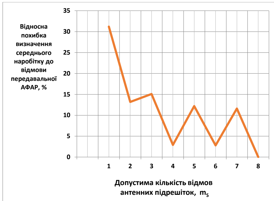
Рис. 3.5 Графік залежності відносної похибки визначення середнього наробітку до відмови передавальної АФАР від допустимої кількості відмов антенних підрешіток
