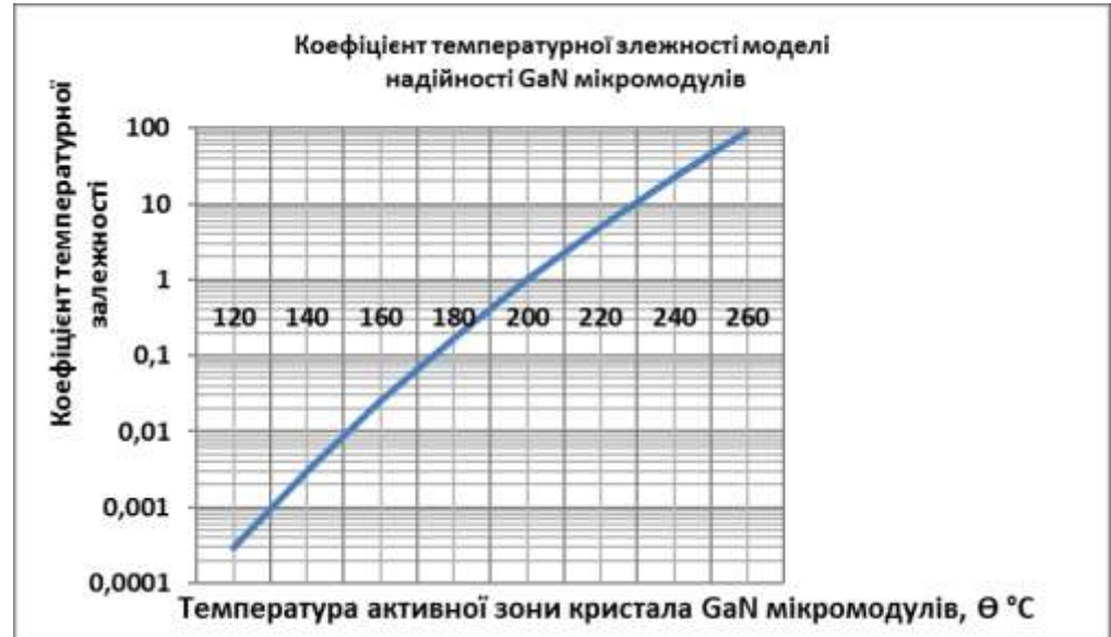
Рис. 3.20 Графік коефіцієнта температурної залежності GaN мікромодулів від температури активної зони кристала мікромодулів
