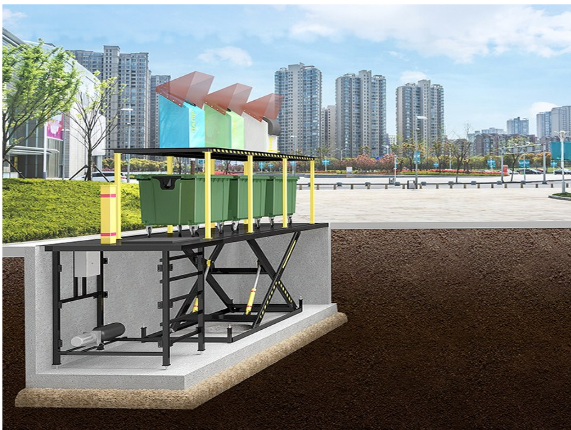
Рис.4.1. Система підземного збору сміття (у піднятому вигляді)
