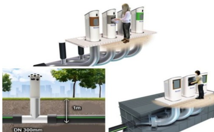
Рис.4.3. Схема вакуумної системи підземного збору відходів
