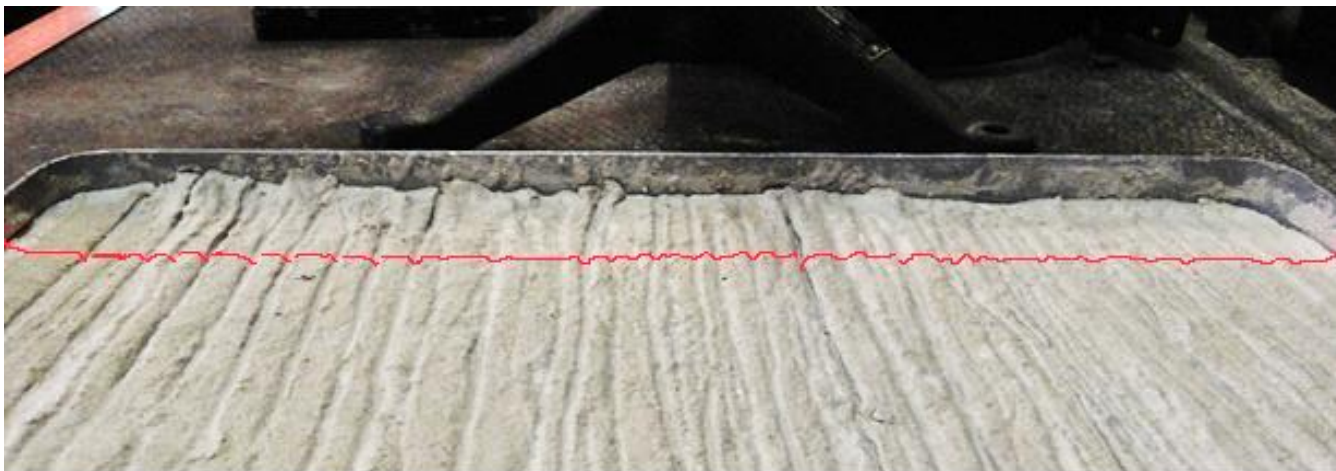
Рис. 4.11. Лазерна лінія на фрагменті поверхні покриття, що досліджується
