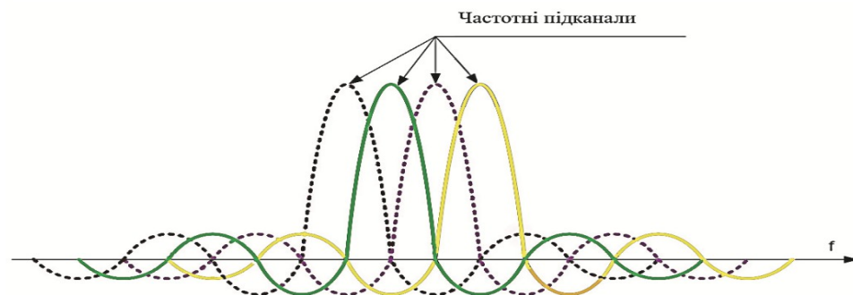
Рис. 3.4. Структура технології OFDM з ортогональними опорними частотами [54]
