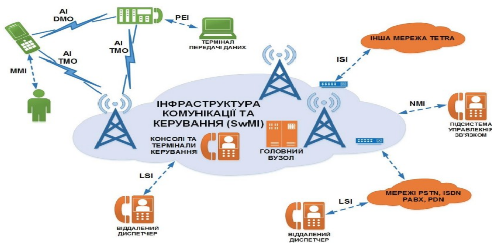
Рис. 1.3 Структурна схема мережі транкінгового радіозв'язку стандарту TETRA[17].
