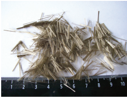
Рисунок 4 – Базальтове рублене волокно (базальтова фібра). Діаметр елементарних волокон 16 мікрон, довжина 12 мм
