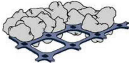
Рисунок 10 – Заклинювання щебеню в отворах геосітки
