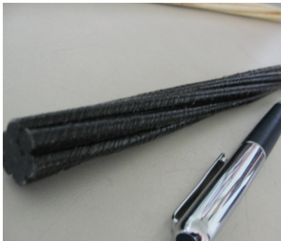
Рисунок 12 – Базальтова композитна арматура
