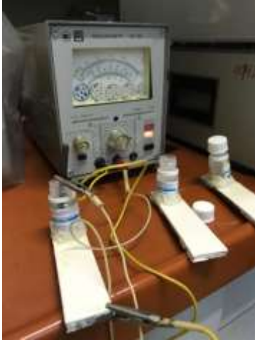
Рис.3.10. Вимірювання перехідного опору.
