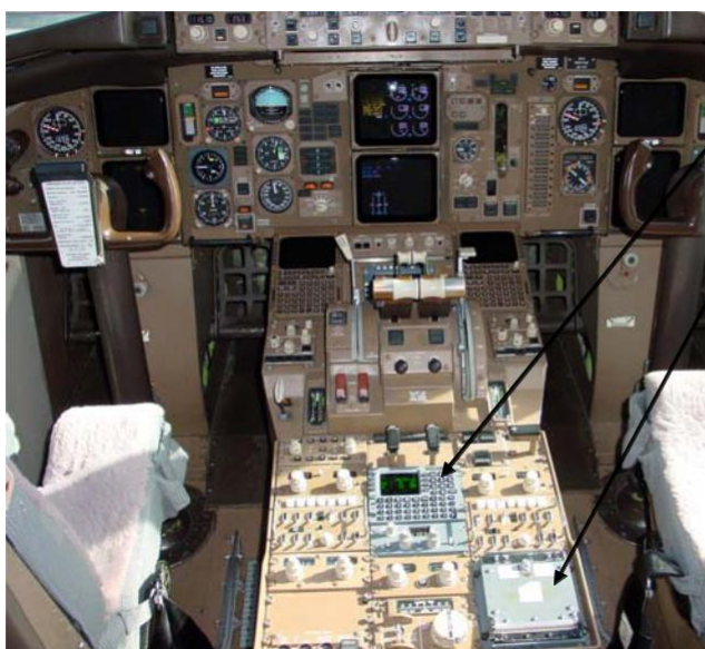
Рис.1.2. Бортовий пульт керування ACARS
