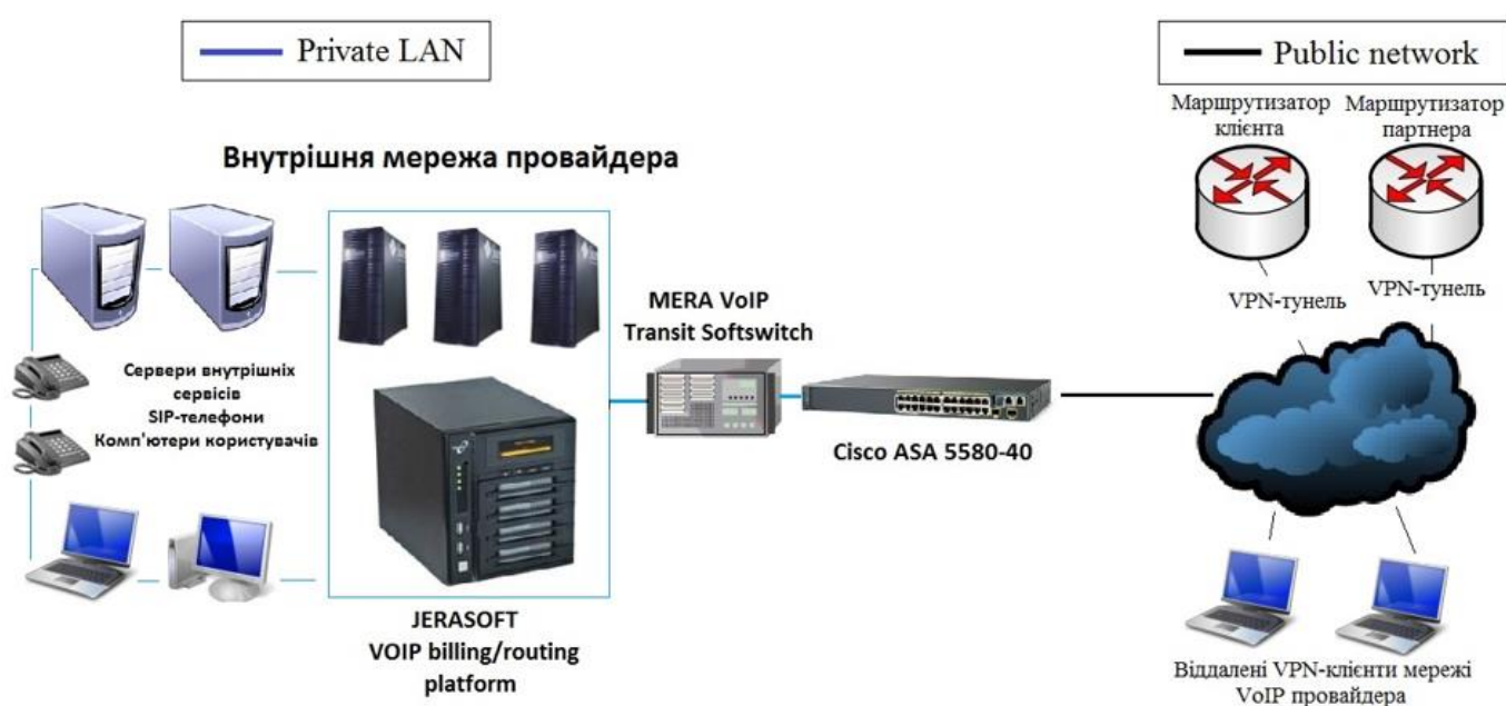
Рис. 4.4. Захищена мережа VoIP провайдера
